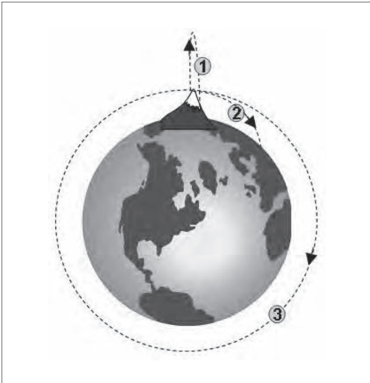
Figura 1. Si lanzamos una piedra hacia arriba con suficiente velocidad, ésta llegará al espacio pero volverá a caer (1). Si la lanzamos hacia delante con suficiente velocidad, a unos 28.000 km/h, se pondrá en órbita (3).
